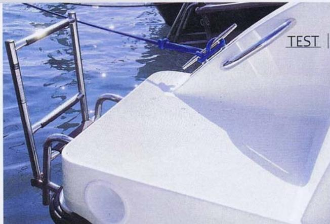
Die zu beiden Seiten der Motorwanne angeordneten Heckstege sind rutschhemmend strukturiert. Die Trittfäche misst 56 x 42 cm
